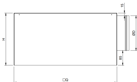
Conectare orizontală (ieșire laterală)
