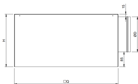
Conectare orizontală (ieșire laterală)
