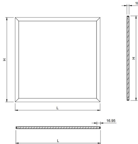
Filtre à air G4 avec encadrement en aluminium, utilisé pour la filtration de l'air et le montage sur le raccord du diffuseur.
