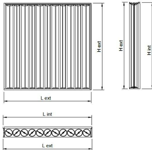
Le registre de réglage est équipé de lamelles opposables et se monte sur le raccord du diffuseur pour régler le débit d'air.
