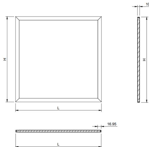
Filtre à air G4 avec encadrement en aluminium, utilisé pour la filtration de l'air et le montage sur le raccord du diffuseur.
