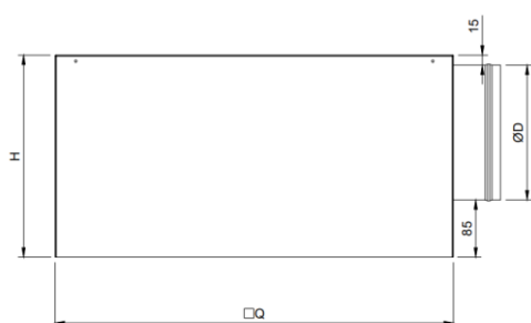
Raccordement horizontal (sortie latérale)
