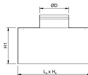
\*Pour fixation avec vis :  $L_A \times H_A = L_{int} \times H_{int} \text{ grille} + 5 \text{ mm}$
