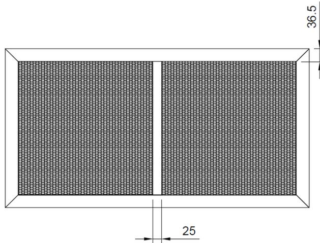
La grille est fabriquée en standard avec des trous chanfreinés positionnés sur le cadre du produit. Le nombre de trous et leur position sont faits en fonction de la taille du produit.
