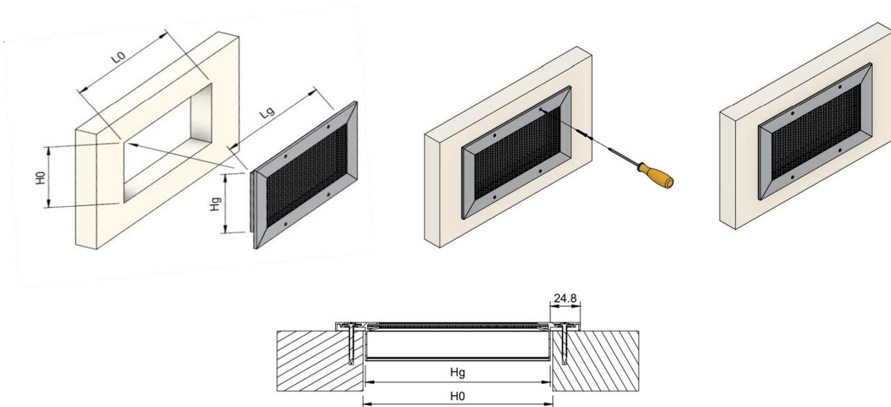
Fixation au mur/plafond avec contre-cadre
