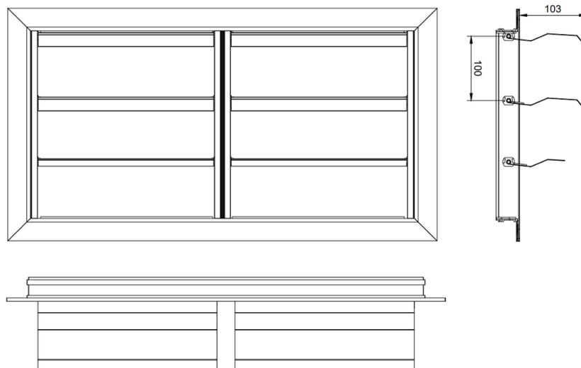
La grille est fabriquée en standard avec des trous chanfreinés positionnés sur l'encadrement du produit. Le nombre de trous et leur position est fait en fonction de la taille du produit, selon les photos et le tableau.
