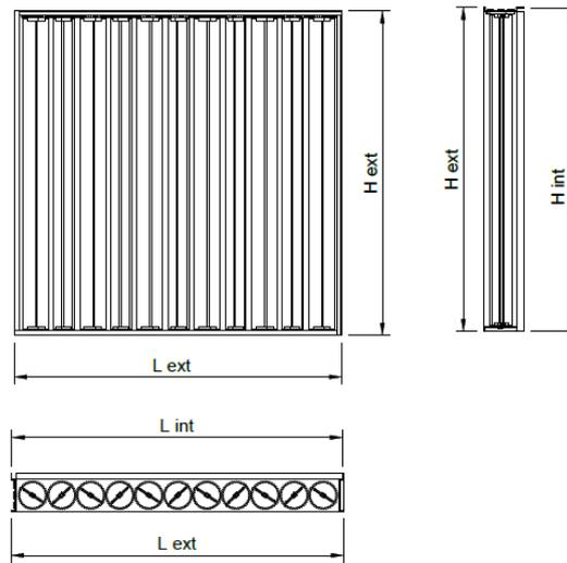
Le registre de réglage est équipé de lamelles opposables et se monte sur le raccord du diffuseur pour réguler le débit d'air.
