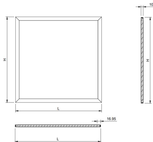
Filtre à air G4 avec encadrement, en aluminium, utilisé pour la filtration de l'air et le montage sur le raccord du diffuseur.
