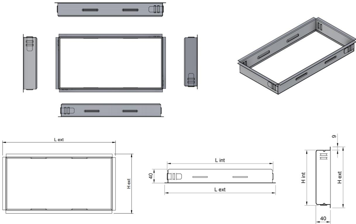
Les grandes dimensions sont constituées de plusieurs pièces/éléments. Le tableau ci-dessous donne le nombre d'éléments à partir desquels un contre-châssis peut être réalisé, en fonction des dimensions.
