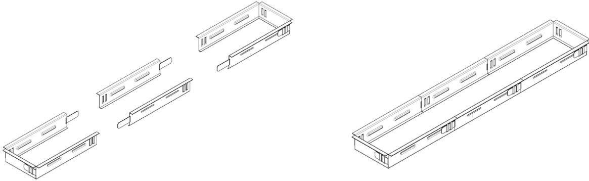
Exemple: montage sur grille (DD) avec contre-cadre
