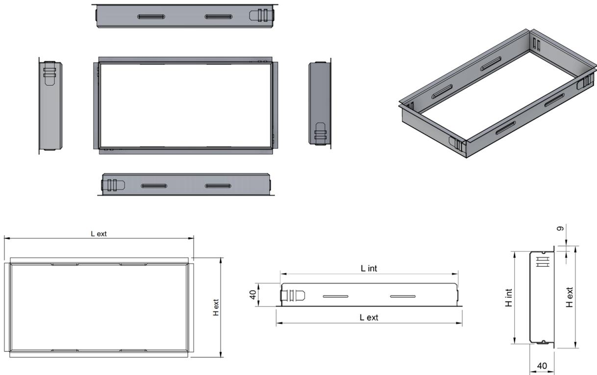
Les grandes dimensions sont constituées de plusieurs pièces/éléments. Le tableau ci-dessous donne le nombre d'éléments à partir desquels un contre-cadre peut être réalisé, en fonction des dimensions.
